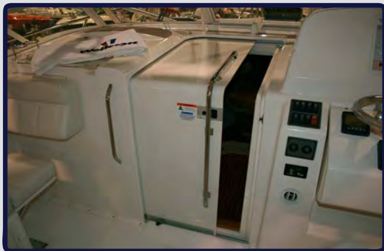
Bent Acrylic Sliding Cabin Entry Door
